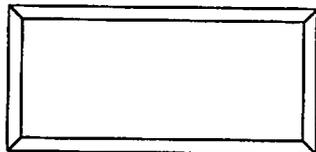
2tのアルミを使用し、周囲を額縁の様に補強してある。
