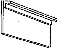
2枚のアルミを使用し、Lアングルで補強してあるもの。
