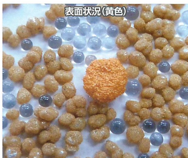
【特殊な反射材を用いた拡大写真(黄色)】
