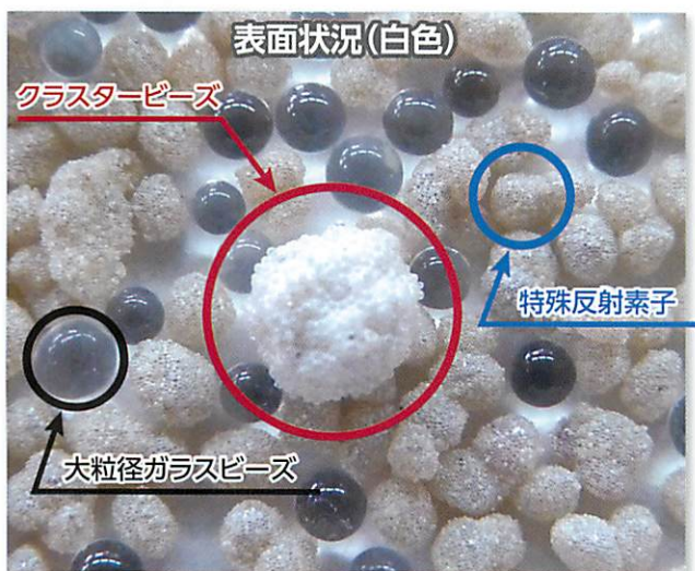
【特殊な反射材を用いた拡大写真(白色)】
