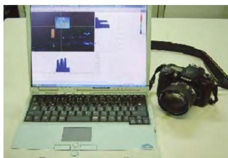
反射輝度測定用デジタルカメラ
