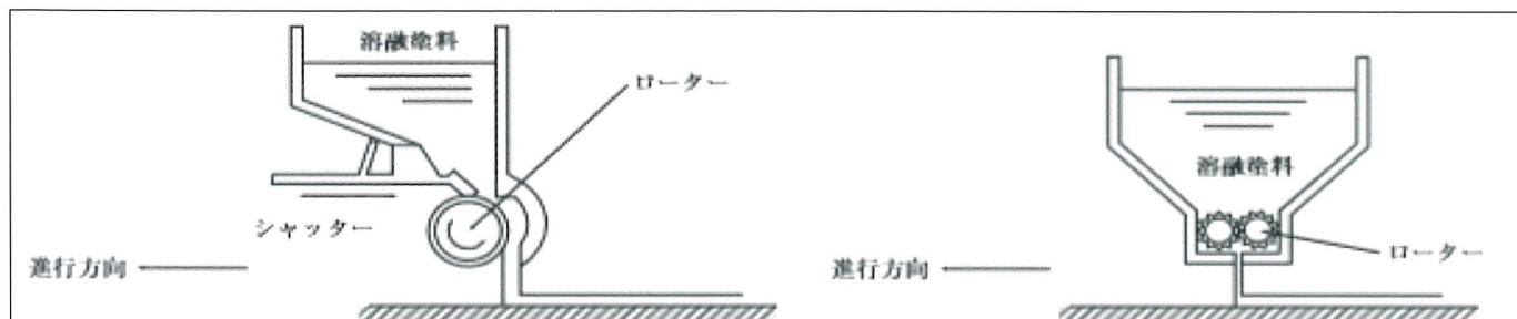
フローコーター工法における施工概略図
