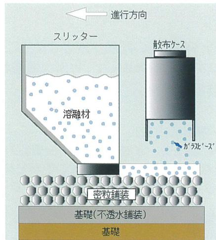
スリット工法における施工概略図
