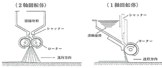
噴射工法における施工概略図
