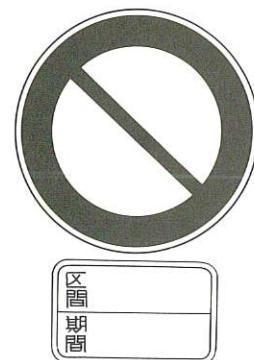
図24 通行の禁止、制限の標示（板）
